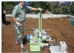
SDS試験機用機。ロッドがめり込んでいく際の力を計測し、地盤の良し悪しを見分けます。
