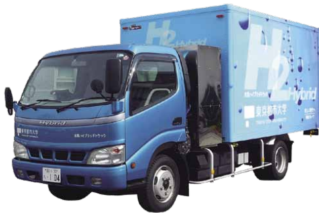
東京都市大学 水素ハイブリッドトラック 仕様概要 排気量:4009cc 最大出力:126SP 最大トルク:320Nm@2200rpm 圧縮比:12:1 車両重量:3640kg(積載重量2000kg、車両総重量5750kg) エンジン:ハイブリッドシステム搭載直列4気筒水素エンジン ベース車両:日野自動車製小型ハイブリッドトラック「デュトロ」
