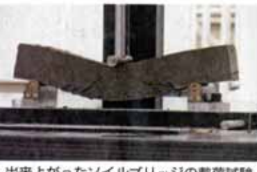
出来上がったソイルブリッジの載荷試験
