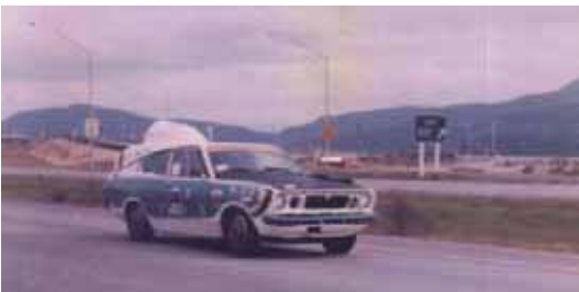
吸気管噴射、火花点火、液体水素、 米国 SEEDラリー出場 2800km走破
