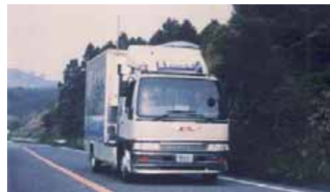
液体水素による保冷車、箱根ターンパイクでの登坂走行
