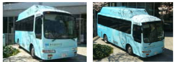
ベース車両：日野リエッセ（排気量：4,728cc） エンジン型式：直列 4 気筒予混合火花点火式水素エンジン 最大出力：105kW（145PS）/3000rpm 最大トルク：350Nm/2000rpm 協力：日野自動車(株)、岩谷産業(株) 外装(ラッピング)デザイン：多摩美術大学
